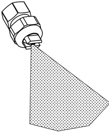
Elegir las boquillas en función de la viscosidad del lubricante y ángulo requerido. Se recomienda usar tuberías rígidas en vez de flexibles, con la menor longitud posible. Pueden obtenerse mejores resultados aumentando la presión de aire en las bombas (hasta 6 bar) y calentando el producto a pulverizar (en el caso de aceite)
